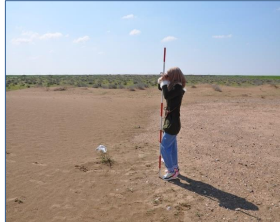
الصورة (٧) قياس الكثبان الرملية باستخدام جهاز (Abney Level)
